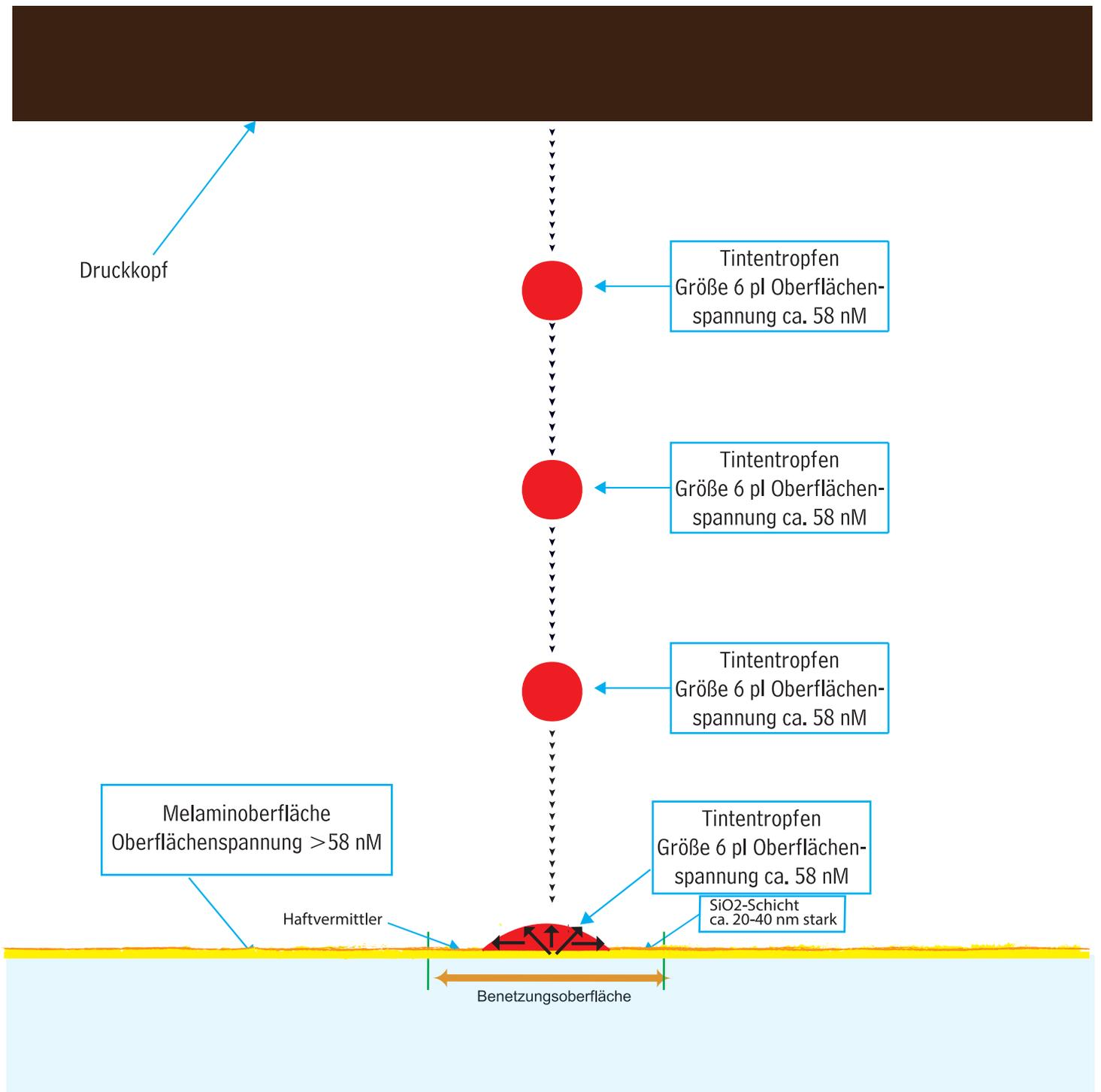
4. Melamin bedruckt welches mit einer Gasflammen-Silikatisierung mit Sauerstoffüberschuss und einem anschließendem Aufbringen eines organofunktionellem Silanprimers durch eine Lackierpistole vorbehandelt wurde.
